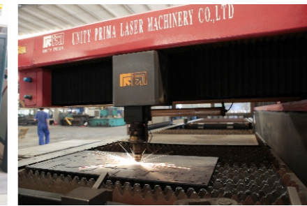
Высокоточная лазерная резка с ЧПУ
